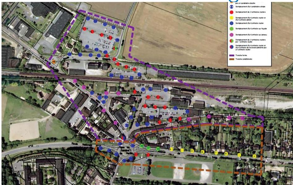
La commune a engagé un programme pluriannuel de remplacement, ou d'équipement progressif de l'ensemble des lanternes d'éclairage public par des dispositifs leds équipés de variateurs d'intensité. Une première tranche a été conduite sur les lampadaires de la résidence du Tapis vert équipée jusqu'alors des lanternes boules d'origine. Des lanternes à leds ont été installées et une diminution de l'intensité de l'éclairage est pratiquée entre 1 h et 5 h 30.
